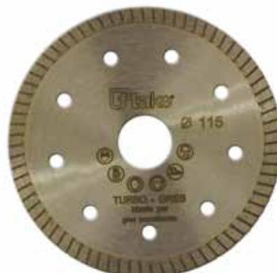
**TURBO-GRES**, disco diamantato con corona continua (7mm di altezza). Raccomandato per il taglio specifico di **ceramica, piastrelle in gres porcellanato e in klinker**. Ø foro 22,2 mm; spessore 1,2mm.
