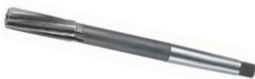
**Alesatori in HSS-Co TA1204**, DIN 208, attacco conico, tolleranza H7, elica sinistra a 5° adatti all'alesatura di tutti i tipi di materiale, a basse velocità di taglio
