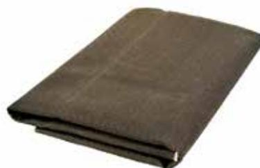
**Coperte di saldatura STRONG**, in panno di fibra di vetro (testurizzata), con pesante rivestimento in PU e grafite su due lati. Struttura molto pesante e resistente (1.100 gr/m<sup>2</sup>). Adatte per utilizzo in orizzontale, per saldature pesanti e lavorazioni a temperature elevate. Resistenti alla temperatura fino a 900°C massimo.
