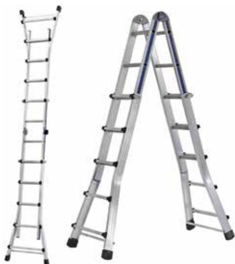
**Scala telescopica UNIVERSALE CLIK CLAK**, in alluminio, multiuso, multiposizione, con cerniera automatica per un utilizzo più facile. Può essere utilizzata: da appoggio, a cavalletto oppure zoppa (adattabile a 2 piani differenti). Montante superiore da 68x25 mm; montante inferiore da 77x26 mm; passo 300 mm; gradini pioli antisdrucciolo; cerniera lamellare fissata ai montanti con ribattitura; tappi antisdrucciolo alle estremità dei montanti; portata massima 150 kg.
