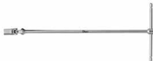
**6076 Chiavi a T snodate con bocca esagonale.** Snodo cardanico; bocca esagonale; asta di manovra scorrevole ed estraibile; acciaio speciale al cromo vanadio; esecuzione cromata.
