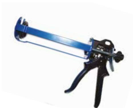
**Pistola sigillante coassiale manuale**, con sistema di spinta ad alta resistenza, fine corsa regolabile e sistema "anti-goccia"; specifica per cartucce bi-componenti da 380/410 ml; rapporto miscelazione 10:1.
