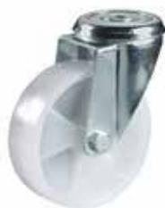
**Ruota monolitica in poliammide, con supporto rotante a foro passante in lamiera stampata e zincata;** gruppo rotante realizzato con doppia corona di sfere. Dado autobloccante al mozzo. Codolo non incluso.
