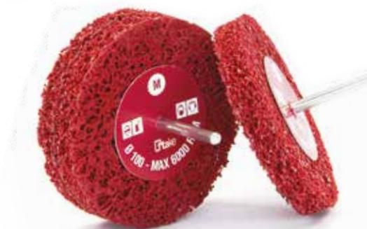
**Dischi su gambo con supporto in fibra TT-RED**, composti da fibre in nylon non tessute impregnate con abrasivo ceramicato in grana grossa. Il materiale ceramico permette una lavorazione uniforme e pulita, riducendo il rischio di intasamento. Ideali per: scrostatura pezzi metallici, rimozione di bave, saldature e vernici, pulitura delle superfici metalliche. Utilizzabili anche su legno, plastica e materiali compositi. Gambo 6mm.
