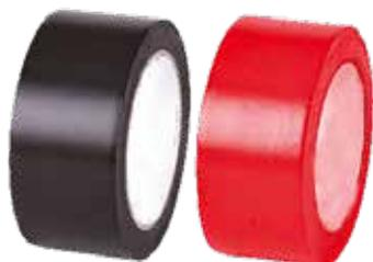
**Nastro isolante**, ignifugo in PVC autoestinguente, ideale per le giunzioni di cavi elettrici e coprifilo; per uso professionale. Resistente alla temperatura da -10°C a +105°C. **Disponibile in due colori:** nero e rosso.
