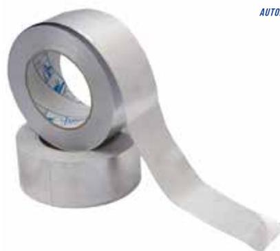
**Nastro adesivo di alluminio**, in acrilico, di elevato spessore; impermeabile e resistente ai raggi UV. Ideale per sigillare tubi di condizionamento, coppelle e lamiere. Trova largo impiego nell'industria frigorifera e di riscaldamento.
