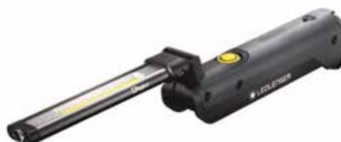
**Torcia da ispezione orientabile**, per uso individuale, dotata di batterie Li-ion ricaricabili tramite USB. Può illuminare con luce diffusa in modo uniforme e due stadi di intensità (flood), oppure in profondità (spot) con lente riflettore. Asta sottile e reclinabile per illuminare in spazi angusti. Dotata di gancio e magnete integrati nel corpo, per consentire diverse soluzioni di fissaggio. Autonomia: 2 h. IP30.
