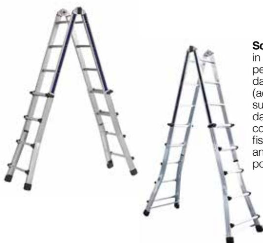
**Scala telescopica UNIVERSALE EN131**, in alluminio, multiuso, professionale, ideale per un uso prolungato. Può essere utilizzata: da appoggio, a cavalletto oppure zoppa (adattabile a 2 piani differenti). Montante superiore da 68x25 mm; montante inferiore da 77x26 mm; altezza 300 mm; gradini pioli con superficie antiscivolo; cerniera lamellare fissata ai montanti con ribattitura; tappi antiscivolo alle estremità dei montanti; portata massima 150 kg.
