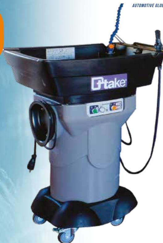
**TOP WASH**, vasca lavapezzi a sgrassatura biologica, ad alte prestazioni, di nuova tecnologia. Riscaldata a 38°C, funzionante con il principio di rigenerazione naturale che utilizza i microrganismi per trasformare semplicemente gli inquinanti in sorgente di cibo e di energia. Questo funzionamento garantisce una sgrassatura efficace ed economica dei pezzi.
