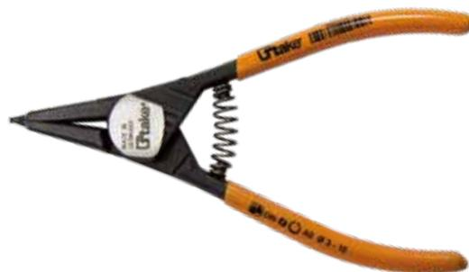
**Pinza per anelli di sicurezza esterni**, manici rivestiti in resina sintetica (pvc), testa bonderizzata nera, per il montaggio di anelli di sicurezza esterni (DIN 471 e DIN 983) su alberi da Ø 3 – 140mm, punte diritte resistenti antiscivolo, DIN ISO 5254 A.
