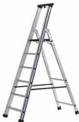
**Scala apribile ISSIMA**, in alluminio, di tipo industriale, con piattaforma ribaltabile automaticamente, parapetto di sicurezza e gradini con superficie antiscivolo. Montanti rettangolari da 70x20 mm; gradini piani da 80x30 mm; gradini fissati al montante con sistema di espansione e risbordatura; altezza 250 mm; cinghie anti-apertura; piattaforma in ABS da 275x260 mm; tappi antiscivolo alle estremità dei montanti; vaschetta porta oggetti in ABS; portata massima 150 kg.
