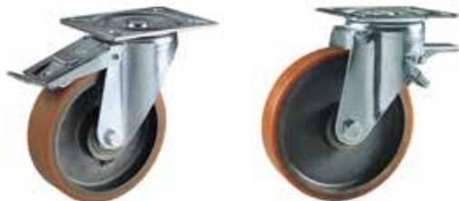
**Ruota con nucleo in ghisa, con supporto rotante a piastra in lamiera stampata e zincata, serie media, con freno totale anteriore**, rivestimento in poliuretano colato con durezza  $92 \pm 2$  Shore A; gruppo rotante realizzato con doppia corona di sfere. Dado autobloccante al mozzo. Mozzo con cuscinetti a sfere.
