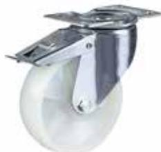
**Ruota monolitica in poliammide, con supporto rotante a piastra in lamiera stampata e zincata e freno totale anteriore;** gruppo rotante realizzato con doppia corona di sfere. Dado autobloccante al mozzo. Codolo non incluso.
