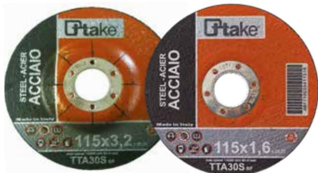
**Mole abrasive piane e a centro depresso da taglio e sbavo, per ACCIAIO:** Adatte al taglio di acciai normali, medio legati e di ghise acciaiose, e allo sbavo di acciai con superficie di molatura estesa e lavorazione di ghise grigie. Bassa asportazione di materiale. Taglio di sezioni medio-grosse con smerigliatrici potenti (2400W), sezioni medio-piccole con smerigliatrici di bassa potenza (1800-2000W). Alta velocità di taglio e buona tenuta del disco.
