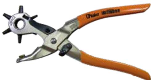
**Pinza a fustella**, manici rivestiti in resina sintetica antiscivolo (pvc), testa cromata, lucida, fustelle intercambiabili Ø 2 - 2.5 - 3 - 3.5 - 4 - 4.5 mm, molla di ritorno, autobloccante, per punzonare fori su cuoio, tessuto e materiale sintetico.
