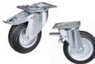
**Ruota con nucleo in lamiera stampata e zincata, con supporto rotante a piastra e freno totale anteriore;** anello in gomma piena nera a profilo trapezoidale; gruppo rotante realizzato con doppia corona di sfere. Codolo non incluso.
