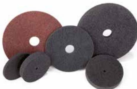
**Disco compatto**, costituito da fibre di nylon con alta concentrazione di abrasivi; adatto alla pulitura di residui di saldatura su acciaio inox, sbavature da taglio laser e rimozione di difetti su superfici delicate; per pulitura e finitura su filetti e lavorazioni speciali su leghe di alluminio, titanio e altri materiali compositi; durezza: soft, medium, hard.
