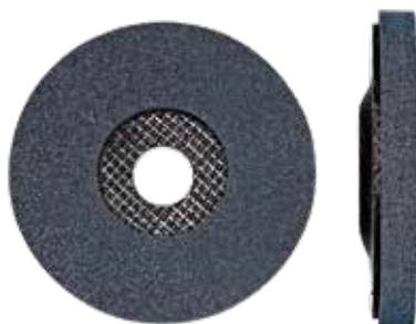
**Disco compatto ad alta densità**, composto da una combinazione di tessuti abrasivi ad altissima densità, con supporto in fibra di vetro; particolarmente indicato per finiture su acciaio inox e come finitura dopo l'impiego di dischi lamellari o dischi fibrati; utilizzabile anche per la preparazione di superfici per trattamenti galvanici o di verniciatura; durezza: soft, medium, hard.
