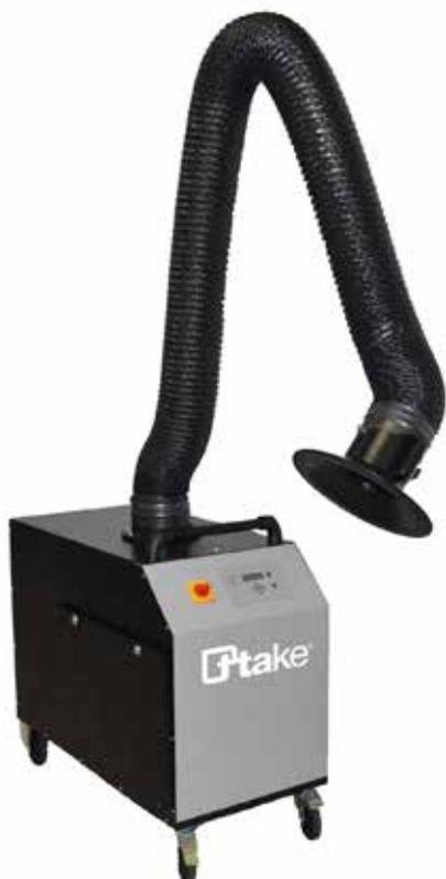
**Unità carrellata per aspirazione fumi saldatura, portata 1400 m<sup>3</sup>/h**, in impieghi poco gravosi. Equipaggiata con una batteria di 4 filtri in sequenza per filtrare meccanicamente e deodorare il fumo aspirato; braccio articolato da 3mt - Ø 160mm incluso; capacità di filtrazione 95%; portata massima 1.400 m<sup>3</sup>/h; superficie filtrante 1,03 m<sup>2</sup>; motore 1,5 HP 400V 50 Hz peso 65 kg. Agile, maneggevole e performante.
